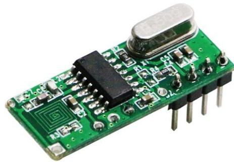
工作模式, 片内自动完成所有的 RF 及 IF 调谐, 省去了软件工程师解码过程中处理杂讯的内容, 方便调试。此型号预设 CE 使能控制脚, 能很好应用于省电模式下; 主要是针对天气预报机开发的, 将室外不同环境下采集到的数据准确接收到, 具超强的抗干扰能力;
