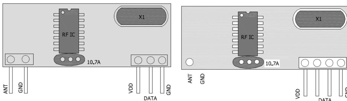
表一 DL-RXP4303 5PIN/4PIN 引脚定义表（出厂默认 4PIN）
